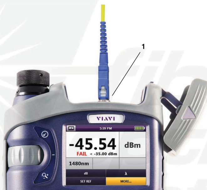
Fig. 20: UPP Power Meter Input
