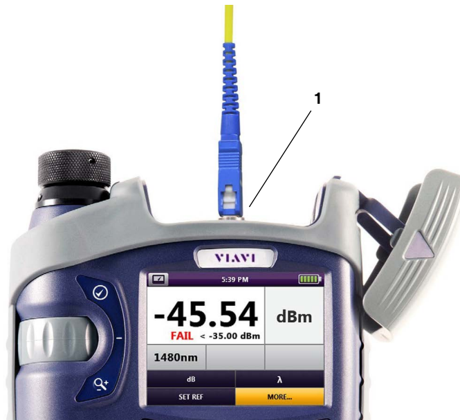
Fig. 20: UPP Power Meter Input
