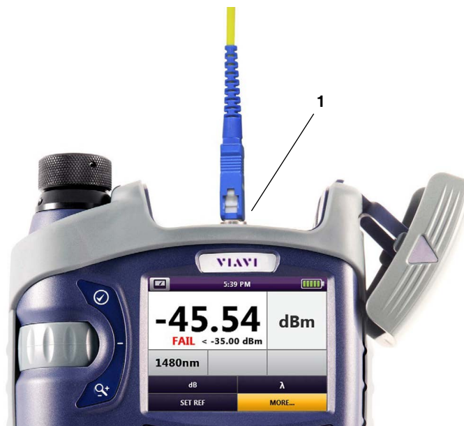
Fig. 20: UPP Power Meter Input
