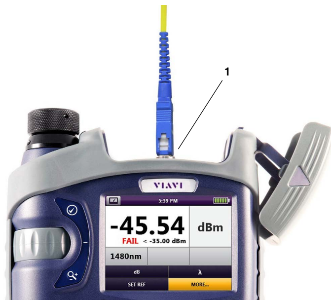
Fig. 20: UPP Power Meter Input
